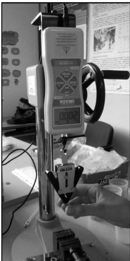
Figura 3. Dinamómetro de precisión para la medida de la fuerza de desprendimiento del fruto.
