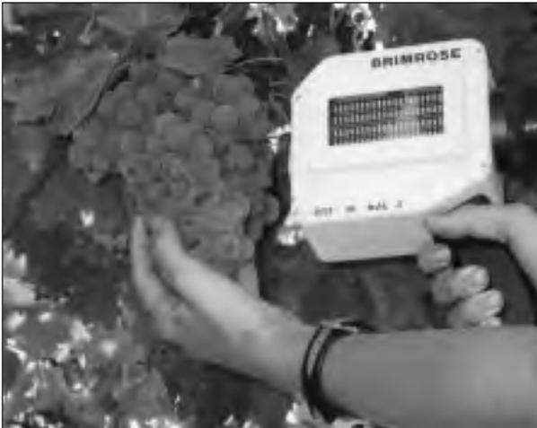
Figura 2. Espectrofotómetro portátil para estimación de parámetros de composición de la uva.
