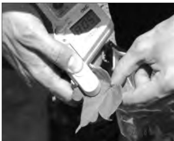
Figura 5. Medida del contenido clorofílico en hoja mediante un espectrofotómetro portátil.
